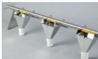
Пробоотборник Uno-Sampler, изготовлен из нержавеющей стали 316/ ПТФЭ, с закрытыми камерами, цветовая маркировка, диаметр 25 мм. Внешняя трубка из нержавеющей стали, камеры для образцов – из ПТФЭ.
