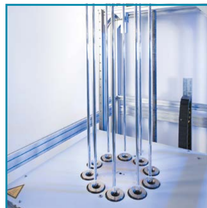
Бюретки изготавливаются с применением вакуумной технологии, что обеспечивает неизменный диаметр бюретки по всей ее длине.
