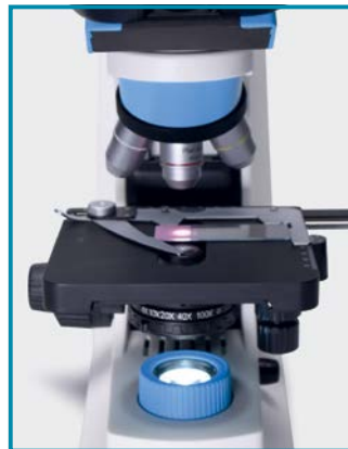
Подвижный столик размером 142x138 мм с движением влево-вправо на 76 мм и вперед-назад на 55 мм обеспечивает простое использование.
