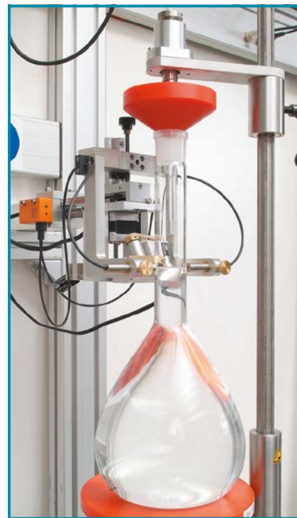
Наполнение заготовок водой выполняется автоматически калибровочными машинами.
