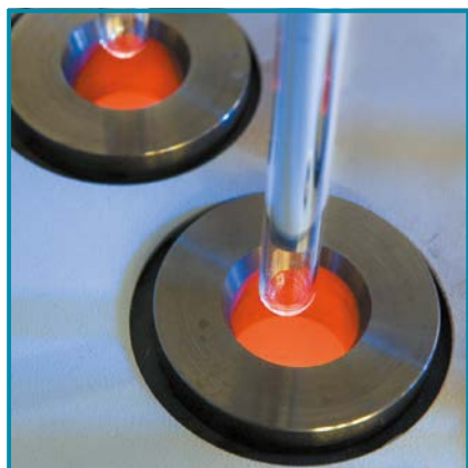
Стеклянные трубки медленно и постепенно нагреваются до уровня полурасплава. Затем они усаживаются вокруг стальных стержней с точным диаметром.
