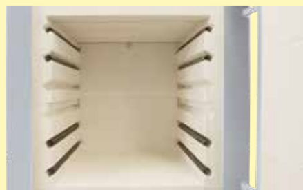
Обогрев с двух сторон при помощи нагревательных элементов, безопасно расположенных в желобках
