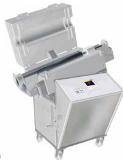
Вращающаяся трубчатая печь, наклоненная влево для опорожнения
