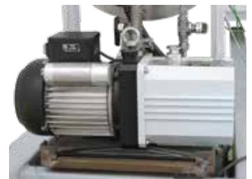
Вакуумный насос для холодного вакуумирования реторты
