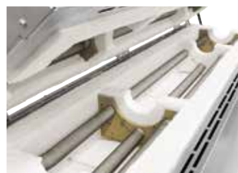
Трубчатая печь RSH 120/1000/11S, управляемый тремя зонами, включая разделители зон для достижения температурного градиента
