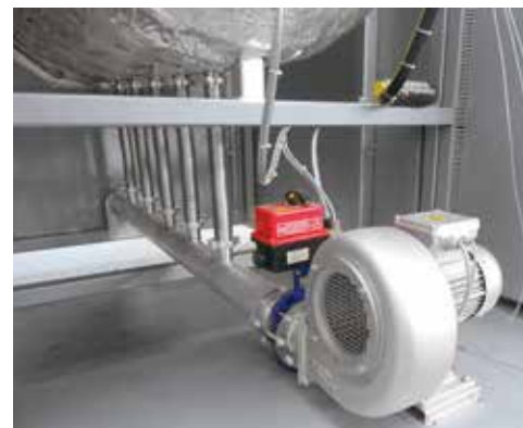
Охлаждение воздуходувкой ретортной печи с горячей стенкой NRA 400/03
