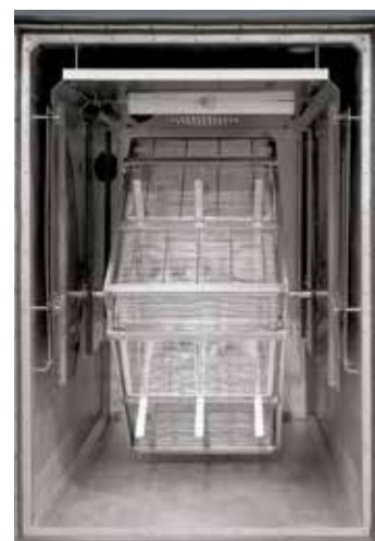
Поворотная тележка с моторным приводом и коробами для перемещения материала во время его тепловой обработки
