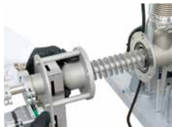
Шнековый транспортер с регулировкой скорости вращения
