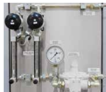
Система подачи негорючих защитных или реакционных газов
