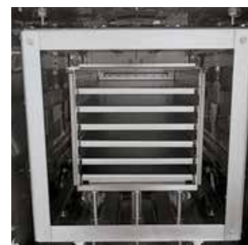
Молибденовый цементационный ящик с шестью подставками для загрузки
