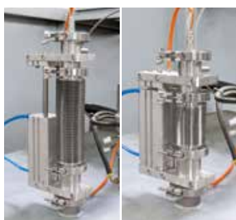
Термоэлемент типа S с автоматическим устройством выдвигания для точного управления в нижнем диапазоне температур
