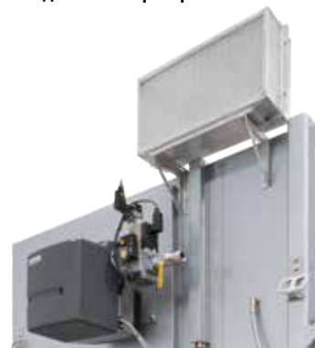
Прямой газовый обогрев в сушильной камере
