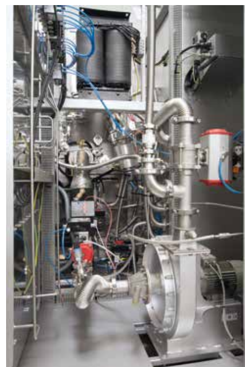
Быстрое охлаждение газом ретортной печи с холодной стенкой VHT 8/16-MO
