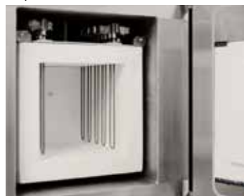
Подогреватель из дисилицида молибдена и волокнистая изоляция
